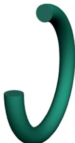
Die ERIKS Präzisions-O-Ringe passen in ISO Bauräume gemäß ISO 3601-4. O-Ringe werden hauptsächlich als statische Dichtung eingesetzt. Der Einsatz in dynamischen Anwendungen für translatorische Bewegungen ist nicht zu empfehlen. O-Ringe können im Verbund als Sekundärdichtung mit weiteren Kolben- und Kolbenstangendichtungen kombiniert werden. O-Ringe aus PUR94 1101 zeichnen sich durch hohe Belastbarkeit im Bereich der Hochdruckanwendungen < 600bar aus.
