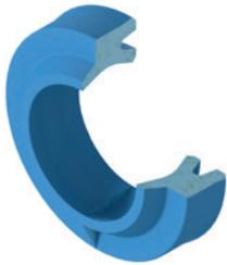
Unsere Hochleistung Polyurethane Abstreifer passen in ISO Bauräume gemäß ISO 5597. Der Doppelabstreifer findet seinen Einsatz in dynamischen Anwendungen und dichtet den Außenbereich der Applikation ab. Doppelabstreifer schützen wirkungsvoll vor eindringenden Schmutzpartikeln beim Zurückfahren der Kolbenstange.
