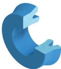
Unsere Hochleistung Polyurethane Kolbendichtungen passen in ISO Bauräume gemäß ISO 5597. Die Kolbendichtungen finden ihren Einsatz in dynamischen Anwendungen für translatorische Bewegungen. Die Kolbendichtungen können als Primärdichtung eingesetzt werden oder im Verbund als Sekundärdichtung mit weiteren Kolben- und Kolbenstangendichtungen. Unsere Kolbendichtungen zeichnen sich durch hohe Belastbarkeit im Bereich Hochdruckanwendungen < 400bar aus.
