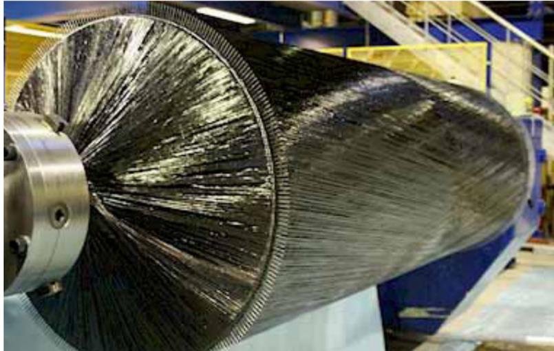
Mittels Filament Winding bzw. Faserwickeltechnik werden heutzutage überwiegend rohrförmige, rotationssymmetrische Bauteile erstellt. Durch die CNC-gesteuerte Faserpositionierung werden belastungsoptimierte Laminatstrukturen standardisiert produziert.
