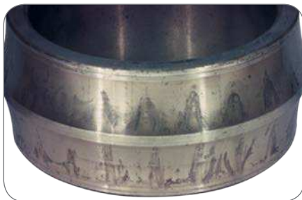
Wasser in Lagern beeinträchtigt die Schmierung und kann dadurch zu erhöhtem Verschleiß und Korrosion führen.
